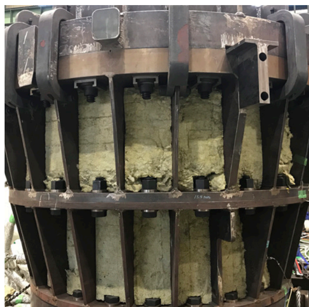
Molde con revestimiento, fijado mediante pernos
