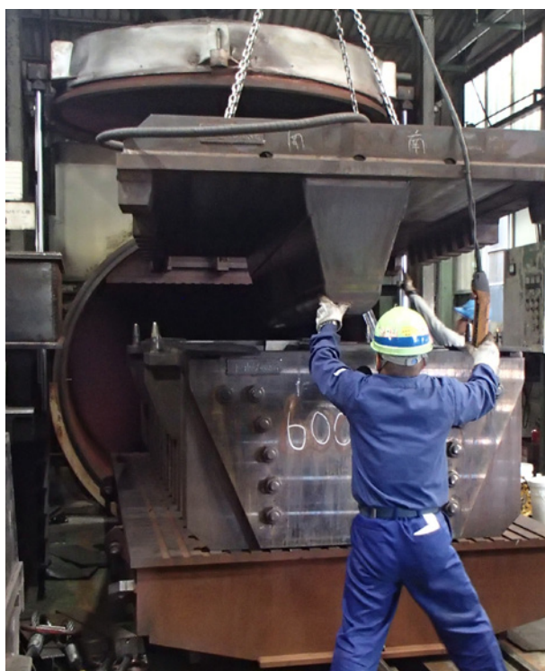
Cierre de un molde con su contramolde antes del curado
