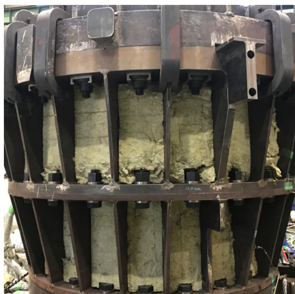
Molde con revestimiento, fijado mediante pernos
