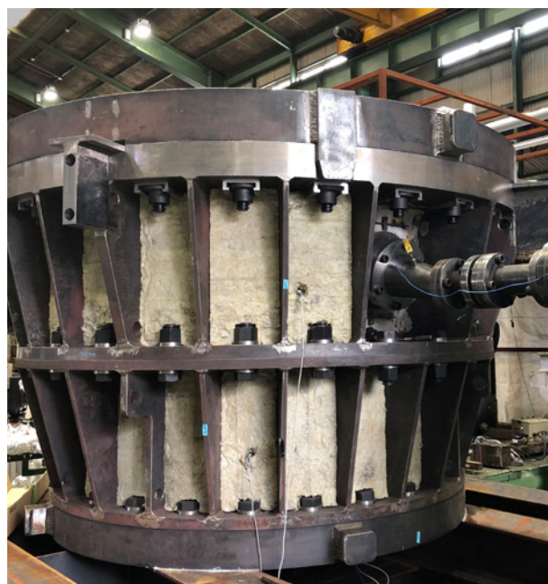
Molde con revestimiento, fijado mediante pernos, durante el proceso de inyección de caucho a alta presión
