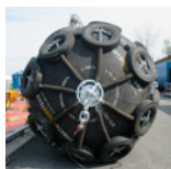
Défenses pneumatiques avec filet de chaîne et de pneus Terminal de croisière Montreal, QC, Canada (2016)
