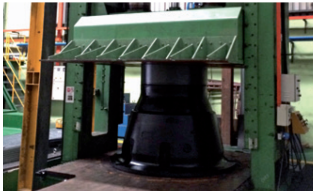
Prueba de defensa de caucho
